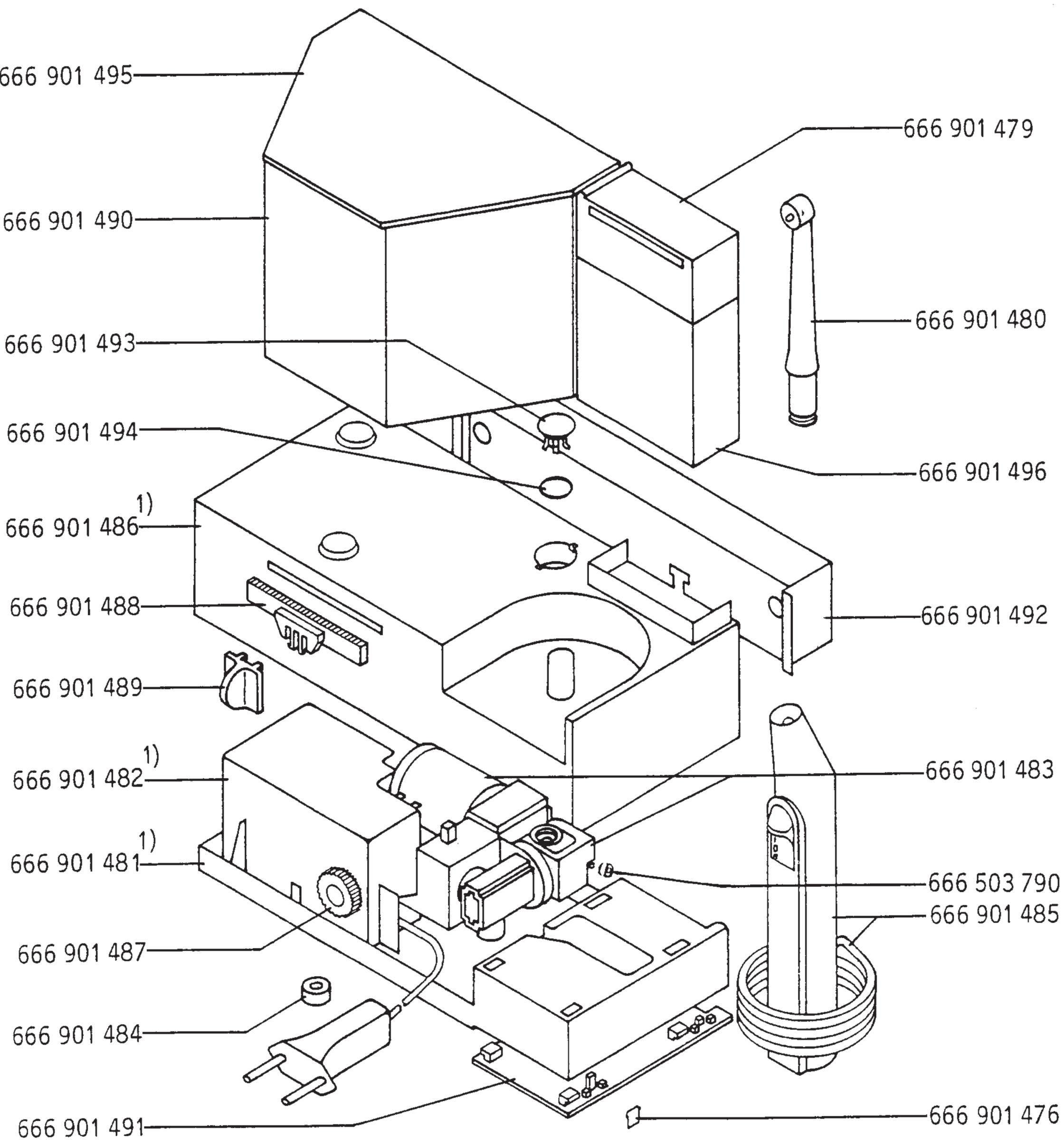
1) Dalla matr.0393: involucro e base con fissaggio a vite
