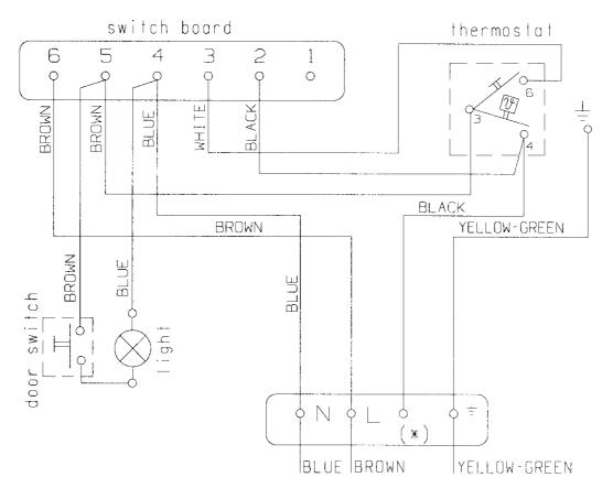
Connector \* is in the junction box market depending an producer of compressor as follows Klemmenbezeichnung \* auf den Kompressoren anschlus bezulich an der Hersteller: Prikljucki \* so v prikljucnici kompresorja oznaceni
